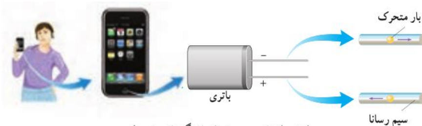
انرژی از باتری به صفحه نمایشگر تلفن، توسط بارهایی که از سیم های رسانا می گذرند، منتقل می شود.
