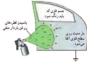
(الف) تصویری از رنگ پاشی الکتروستاتیکی (ب) اساس این رنگ پاشی مبتنی بر پدیده القای بار الکتریکی است.
