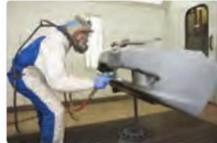
(الف) تصویری از رنگ پاشی الکتروستاتیکی (ب) اساس این رنگ پاشی مبتنی بر پدیده القای بار الکتریکی است.
