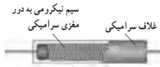
نمونه ای از ساختار یک مقاومت پیچه ای
