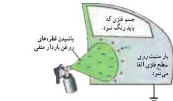
(ب) اساس این رنگ پاشی مبتنی بر پدیده القای بار الکتریکی است.
