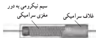
نمونه ای از ساختار یک مقاومت پیچه ای
